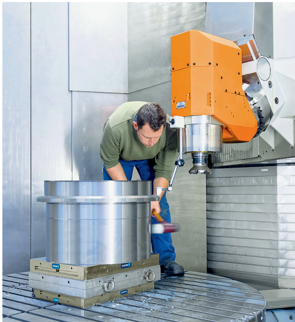
5 Ob rund, eckig oder kubisch, ob Stahl oder Guss – Stock bearbeitet unterschiedlichste Präzisionsteile auf der Maschine. Bei diesem flachen Spannungring zählt sich die deformations- und störkonturfremde Spannung mit Magnos gleich doppelt aus. 6 Drehteile richtet der Maschinenbediener innerhalb kürzester Zeit mit einer Rundlaufgenauigkeit von 0,01 mm unmittelbar auf den Schunk-Magnetplatten aus. Sobald die Position stimmt, wird die Spannlösung über einen kurzen Stromimpuls aktiviert.
